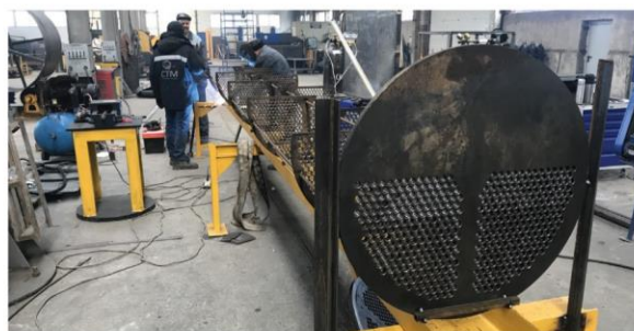
Монтаж деталей АБХМ для АЭС в Тверской области
